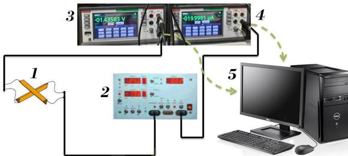
Рис. 2.7. Загальна схема каналу вимірювання ВАХ мікроконтактного спектрометра. 1 – точковий контакт Янсона, сформований за методом зсуву Чубова; 2 – джерело струму; 3, 4 – мультиметри Keithley DMM6500; 5 – персональний комп'ютер.
