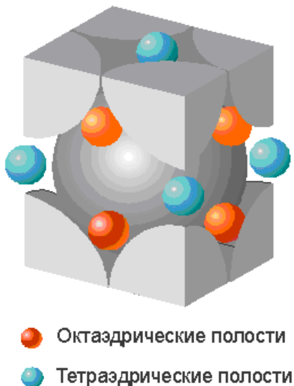
Рис.1.2 Элементарная ячейка кристалла фуллерита C_{60} .
