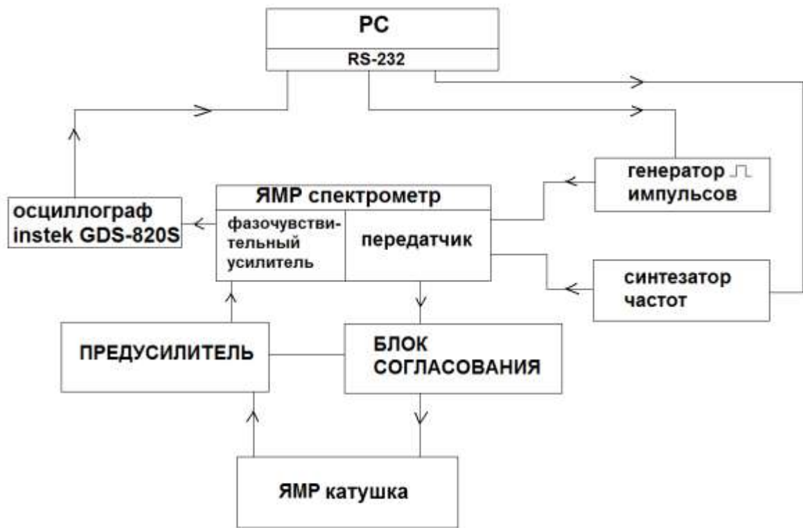
Рис.2.5 Схема измерений методом импульсного ЯМР.
