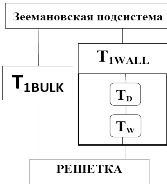
Рис. 4.15 Пути спин-решеточной релаксации в сверхтекучем включении и массивном образце.
