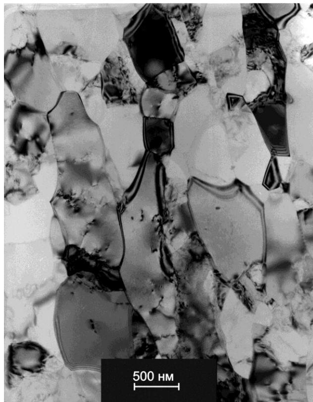
Рис. 2.3. Микрофотография структуры алюминия (полученная ТЕМ) после 8 проходов РКУП.
