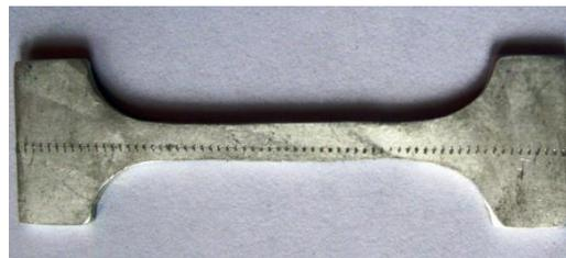
Рис.2.9. Вид образца после деформации, с нанесенными метками.
