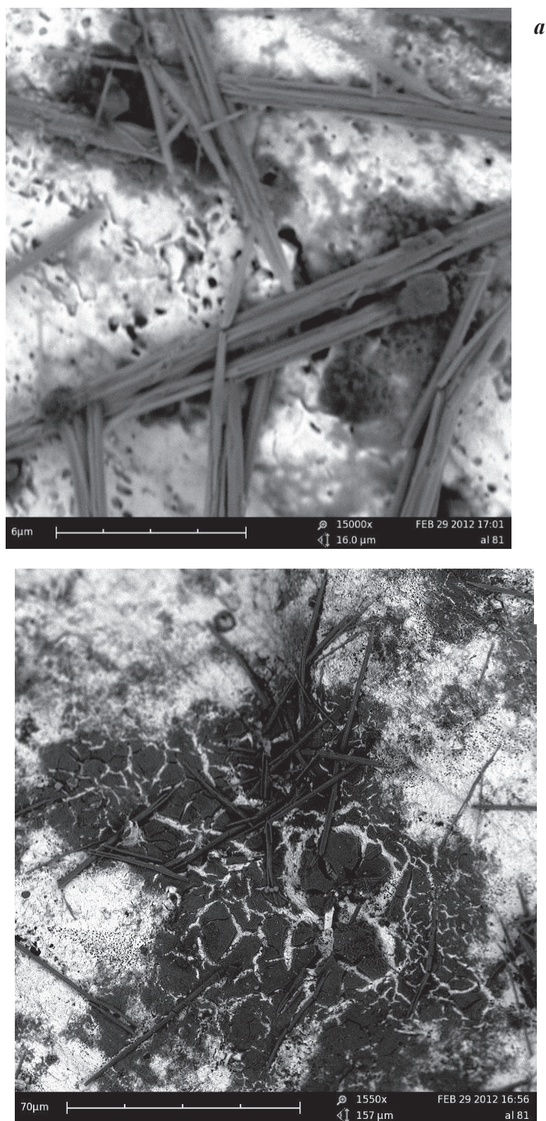
Рис. 4. Электронно-микроскопические снимки пленки закристаллизовавшегося расплава Al+4 ат.% Li после травления. Снимок сделан с помощью микроскопа PHENOM с увеличением \times 450 (а, б – различные участки образца)
