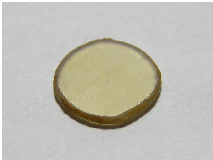
Рис. 3.5. Зразок титанату стронцію з атомно гладкою поверхнею, який використовувався у даній роботі для досліджень методом дифракції швидких електронів на відбиття.
