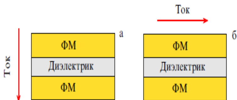
Рис.1.2. Тунельна магнітна структура в геометрії струм перпендикулярно площині (а) і струм в площині (б).
