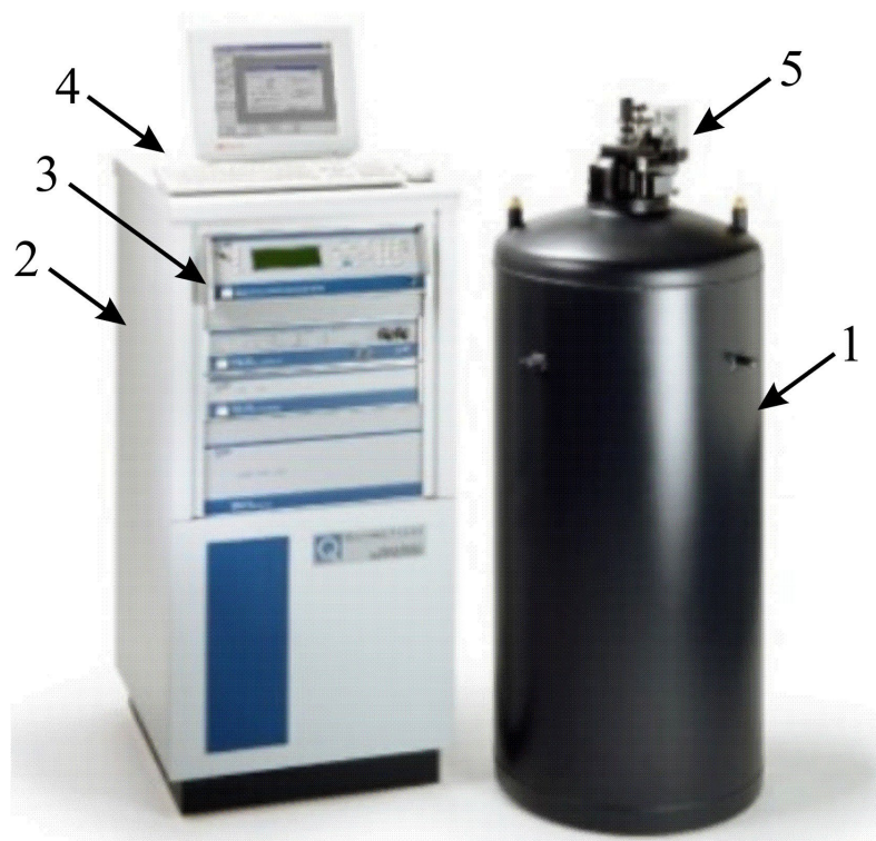
Рис. 1.12 Комерційна автоматизована установка PPMS-9T фірми Quantum Design [63]. 1 – кріогенна частина (азотний, гелієвий кріостати та супутнє обладнання); 2 – стенд з вимірювальною апаратурою; 3 – контролер PPMS Model 6000; 4 – комп’ютер; 5 – місце для введення вимірювальних вставок.
