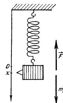
Сравнивая это уравнение с уравнением движения гармонического осциллятора  $\ddot{s} + \omega^2 s = 0$ , мы видим, что пружинный маятник совершает колебания по закону  $x = A \cdot \cos(\omega t + \varphi)$  с циклической частотой и периодом
