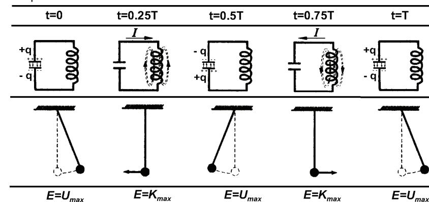
Пусть в начальный момент времени  $t = 0$  конденсатор заряжен зарядом  $q$ . Тогда энергия электрического поля между обкладками конденсатора  $W_e = \frac{q^2}{2C}$ . При замыкании конденсатора на катушку индуктивности, в контуре потечет возрастающий ток  $I$ . Энергия электрического поля начнет уменьшаться, а энергия магнитного поля катушки  $W_m = \frac{LI^2}{2} = \frac{L\dot{q}^2}{2}$  будет возрастать. Поскольку потеря в контуре нет ( $R = 0$ ), то полная энергия
