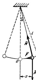
Следовательно, движение математического маятника описывается дифференциальным уравнением гармонических колебаний, то есть происходит по закону  $x = A \cdot \cos(\omega t + \varphi)$  с частотой и периодом, соответственно
