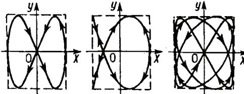
Вид этих кривых зависит от соотношения амплитуд, частот и разности фаз складываемых колебаний. На рисунке показан вид фигур Лиссажу при трех различных значениях отношений (2:1, 3:2, 4:3) и разности фаз  $\alpha = \frac{\pi}{2}$ .
