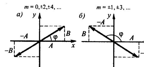
Если разность фаз равна  $\alpha = m\pi$  ( $m = 0, \pm 1, \pm 2, \dots$ ), то эллипс вырождается в отрезок **прямой**
