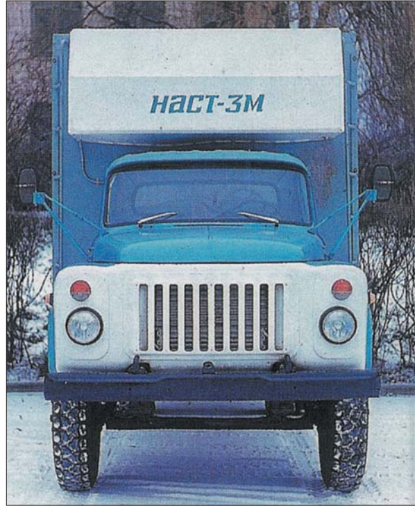
Фото 8. Автомобіль з азотною системою охолодження (НАСТ-3) для тривалого зберігання продуктів харчування під час їх перевезень
