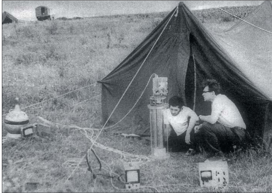
Фото 2. Перші польові випробування надпровідного квантового магнітометра. Біля приладу С.І. Бондаренко (праворуч) і Є.М. Тільченко. 1974 р.
