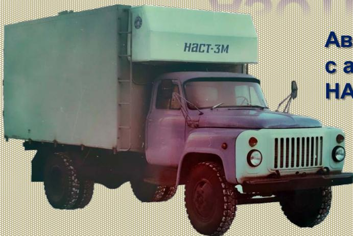
**Авторефрижератор с азотной системой НАСТ-3М**
