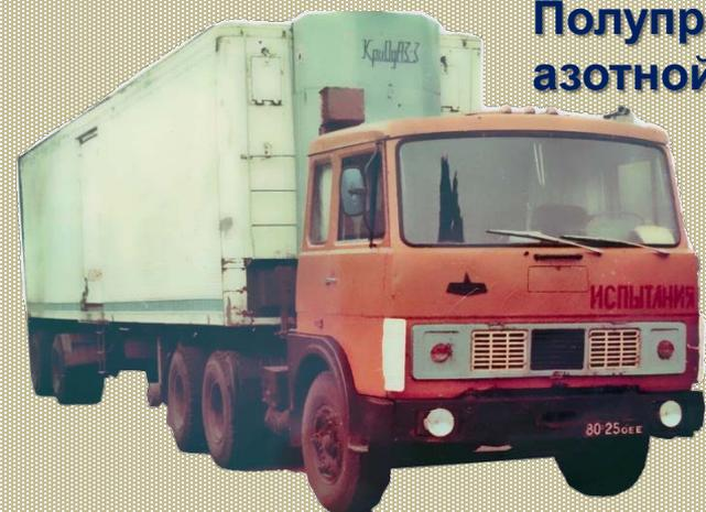
**Полуприцеп-рефрижератор с азотной системой КриОДАЗ-3**
