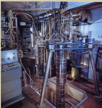
Рефрижераторы для получения сверхнизких температур ( $\sim 0,0007$  К)
